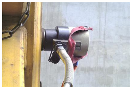
Auszugswerkzeug „Puller“-Zylinder für Konusbolzenverschraubungen an Kranen.
