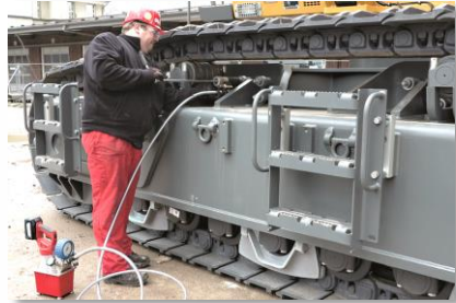
ITH Schraubenspannzylinder M16 bis M800, zum hydraulischen, reibungs- und torsionsfreien Vorspannen.
