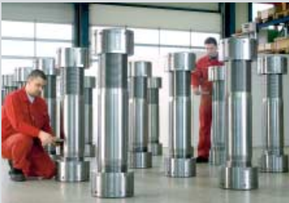
Passschrauben M 245 für Wasserturbinen
