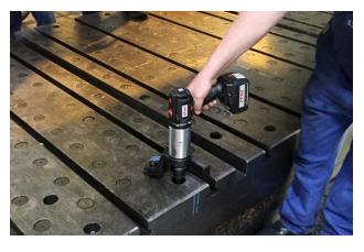
Flexibel einsetzbar: Die M30 Innensechskantverschraubungen einer Blechstanze werden mit dem ITH ADS-150 bei 1.250 Nm verschraubt.
