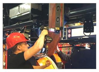
Ausgelegt für Service-Anwendungen: Mit dem ITH ADS -150 werden hier Schraubenverbindungen eines Schiffcontainer-Transportfahrzeugs ("Straddle Carrier") schnell und präzise angezogen.
