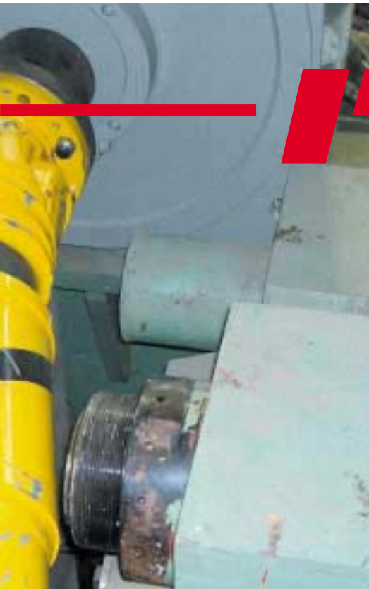
ITH-Zugmutter TN 140 Vorspannen von Dehnschrauben M 140 x 6 an einem Walzgerüst unter beengten Platzverhältnissen
